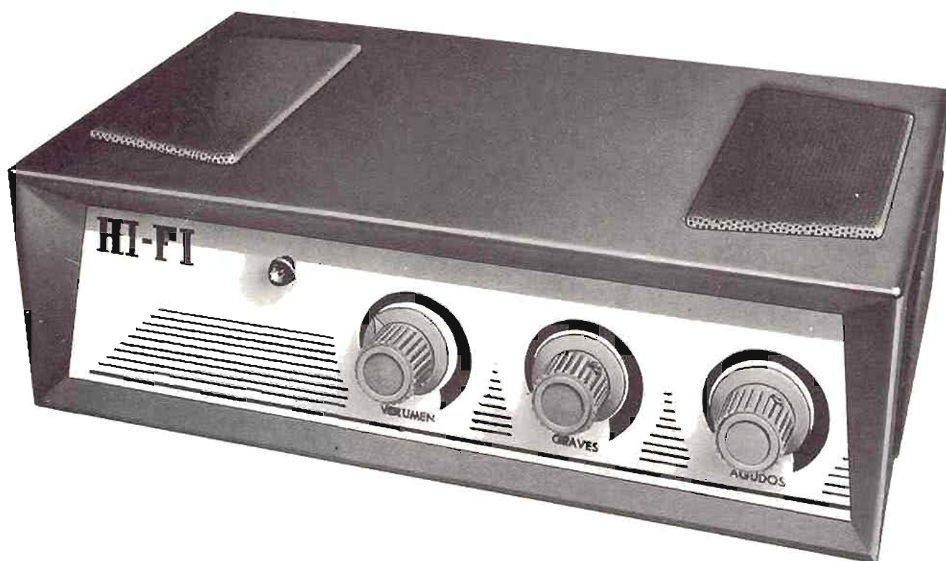
Aspecto que ofrece el amplificador una vez introducido en la caja. Este es el resultado final de nuestro montaje.
